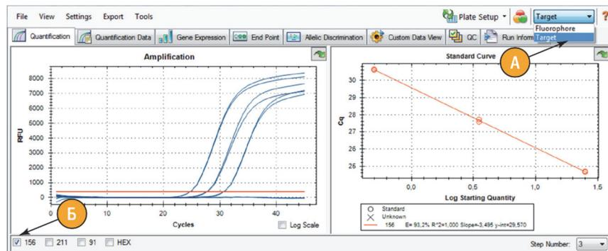
Рисунок 4 – выбор режима анализа «Мишень» (правый верхний угол) и выбор мишени под полем «Амплификация» (Amplification).
