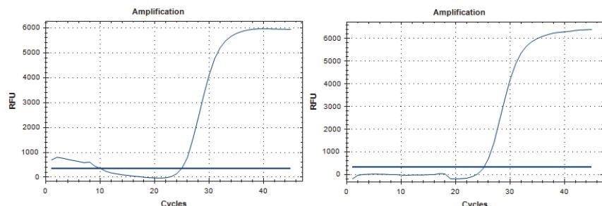
**Рисунок 1** – примеры аберрантных кривых флуоресценции (отличаются от горизонтальной прямой на уровне 0 RFU после десятого цикла и до начала экспоненциальной фазы кривой накопления продукта).
