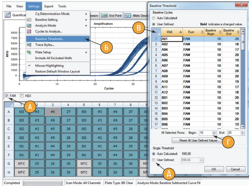
Рисунок 3 – окно «Пороговый уровень базовой линии» (Baseline Threshold).
